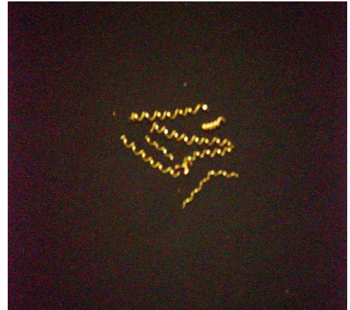
b - السبيكة أالمنتجة باستخدام مساعد صهر (A) شكل الرايش مستمر
